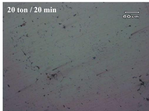
Gambar 4.4 Foto mikro material bronze *bearing* (90Cu-10Sn) setelah sinter
