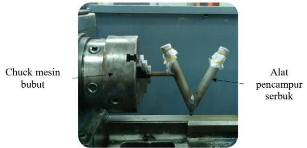
Gambar 3.1 Alat bantu pencampur serbuk pada mesin bubut
